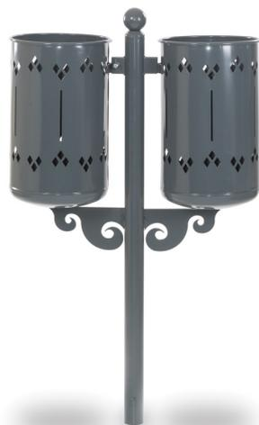
Realizzato con paletto di sostegno in tubo tondo di acciaio Ø 60 mm e altezza cm 130 da interrare. In cima al paletto vi è un copritubo ornamentale in ghisa. A sostegno dei cestini, nella parte inferiore del paletto vi sono due moduli ornamentali sagomati in lamiera spessore mm 6. Cestini di forma cilindrica in lamiera di acciaio con motivi geometrici. Sganciamento e ribaltamento con chiave a brugola fornita in dotazione. Interamente zincato e verniciatura a forno a 180°C.
