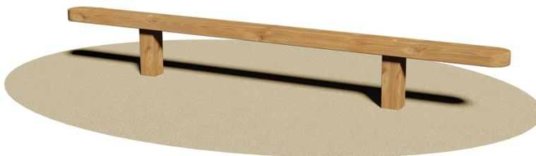
Asse di Equilibrio in legno. Certificato in conformità delle Norme Europee EN 1176 dall'Istituto Tedesco TÜV - SÜD. Realizzata in legno di pino nordico impregnato in autoclave con sali atossici. Trave avente sez. cm 6x16 sostenuta da due pali verticali di sez. cm 9x9 per un'altezza complessiva di cm 33. Assemblaggio mediante bulloneria in acciaio zincato 8.8 e dadi autobloccanti. Elementi copridado a norma in nylon colorato.
