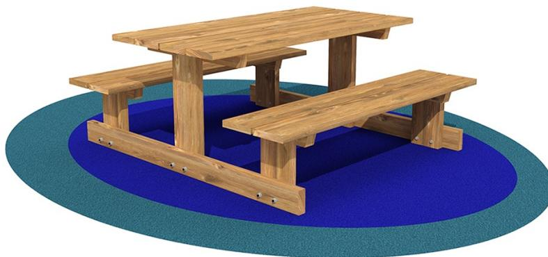
Struttura realizzata in legno di pino nordico impregnato in autoclave con sali atossici. Lunghezza cm 120. Combinazione monoblocco di tavolo con due panche incorporate. Le panche e il piano del tavolo sono costituiti da listoni di sezione mm 140 x 25. Assemblaggio mediante bulloneria in acciaio zincato 8.8 e dadi autobloccanti. Il set viene fornito in kit di montaggio.
