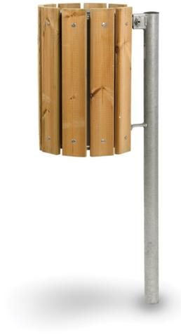
Cestino in legno per parchi pubblici. Realizzato con paletto di sostegno in tubo tondo di acciaio zincato a caldo Ø 50 mm e altezza cm 120 da interrare. Cestino di forma cilindrica in lamiera di acciaio rivestito con fasce in pino nordico impregnato in autoclave con sali atossici. Interamente zincato. Sganciamento del cestino con chiave a brugola fornita in dotazione.
