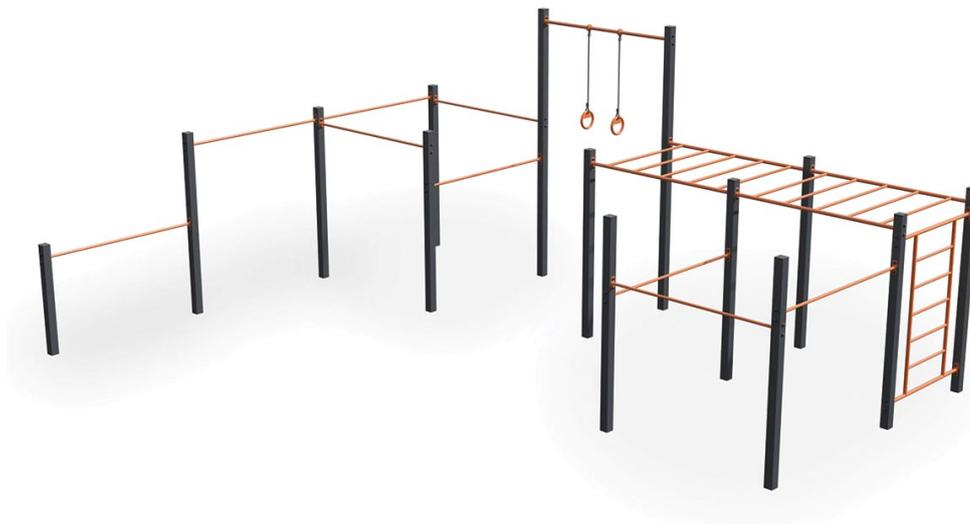
Dispone di diverse altezze di barre. Struttura realizzata con pali in alluminio verniciati a forno. Barre in tubo sezione Ø30 mm in acciaio verniciato a forno con finitura antiscivolo. Bulloneria in acciaio zincato M12. Fissaggio in acciaio zincato M12.
