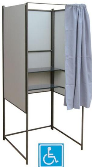
Costituita da un unico blocco. Struttura in tubo tondo di acciaio zincato. Munita di robusti pannelli di tamponamento in lastre di PVC espanso (ignifugo classe 1) fissati con sistema di incastro su appositi canaletti per consentire un'eventuale sostituzione semplice e rapida.
