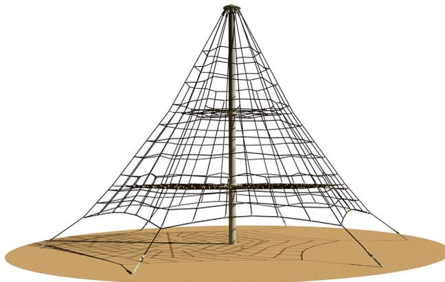
Costituito da un montante principale in acciaio zincato a caldo assemblato ad una rete piramidale mediante connettori in alluminio. La rete piramidale è composta da fune armata Ø 18 mm. Sistema di ancoraggio: da interrare.
