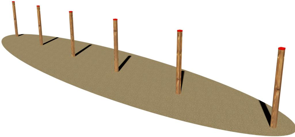
Realizzato in legno lamellare di pino nordico impregnato in autoclave con sali atossici. Costituita da n° 6 montanti verticali posizionati consecutivamente a idonea distanza. Assemblaggio mediante bulloneria in acciaio zincato 8.8 e dadi autobloccanti. Elementi copridado a norma in nylon colorato. Tappi copripalo in polietilene.
