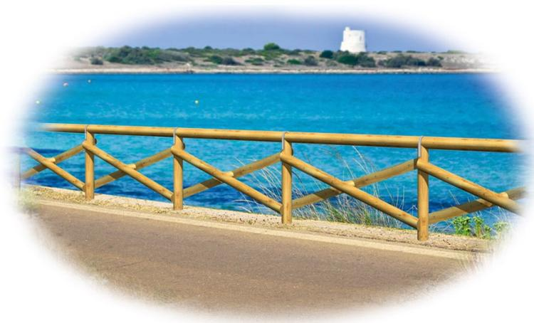
Recinzione arredo parco giochi Portofino. Realizzati in legno di pino nordico impregnato in autoclave con sali atossici. Moduli di lunghezza cm 200. Ogni modulo è costituito da un montante  $\varnothing$  10 cm e una traversa orizzontale mezzo tondo  $\varnothing$  10 cm, privi di spigoli vivi, due traverse oblique in legno mezzo tondo disposte a croce di Sant'Andrea di  $\varnothing$  10 cm. La recinzione viene fornita al cliente in kit di montaggio, esclusa viteria.
