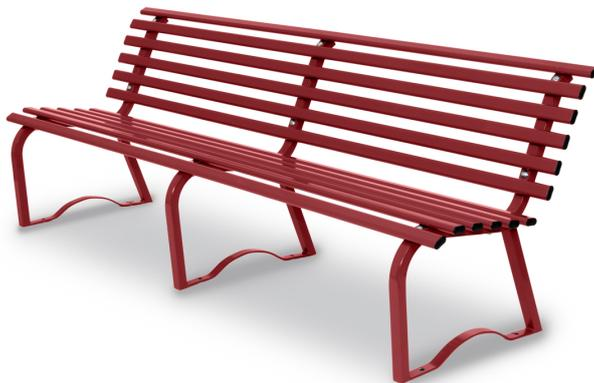
Struttura con n° 3 supporti in tubo quadro di acciaio sezione mm 30x30, di forma anatomica. Lunghezza cm 200. Scocca composta da dodici profili in acciaio di sezione ovale mm 40 x 20 dotati di tappi in plastica alle due estremità. Fissaggio ai supporti mediante bulloneria in acciaio zincata. Predisposta per l'ancoraggio nel terreno. La panca viene fornita al Cliente in kit di montaggio. Interamente verniciata a forno a 180°.
