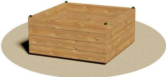
Realizzata interamente con fasce in legno di pino nordico impregnato in autoclave della sez. cm 11 x 4,5 e base in multistrato di betulla ad incollaggio fenolico con film colorati in entrambi i lati dello spessore di cm 1,9. Il tutto assemblato con bulloneria in acciaio zincato. La fioriera viene fornita al Cliente in kit di montaggio.
