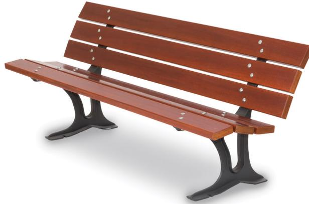
Panca con due supporti in ghisa, sei doghe in legno tropicale sez cm 11 x 3,3 e bulloneria in acciaio zincato. Trattamento del legno con protezione fungicida e idrorepellente. Supporti trattati con primer e verniciati a forno, muniti di attacchi per fissaggio al terreno. Articolo versione **TIPO B** (FILO PAVIMENTO) munito di attacchi in acciaio zincato per l'ancoraggio da interrare. L'articolo viene fornito in **kit di montaggio**.
