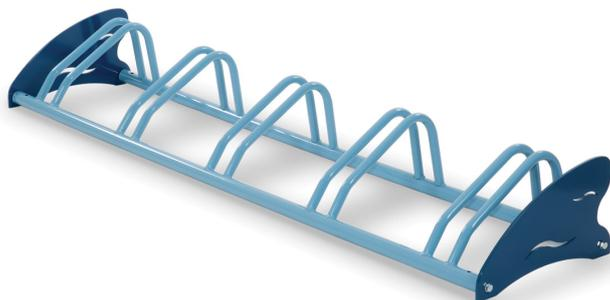
Composto da n. 2 supporti sagomati in lamiera spessore 8 mm. Struttura portabici a cinque posti, realizzata in tubo tondo Ø 40 mm e tubo tondo Ø 25 mm. Predisposto per l'ancoraggio al terreno. Il portabici viene fornito al cliente in kit di montaggio. Interamente zincato e verniciato a forno a 180°C.
