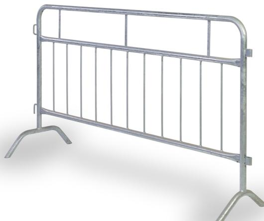
Zincatura a caldo. Struttura in tubo tondo di acciaio da  $\varnothing$  mm. 35, sbarre verticali in tondo pieno da  $\varnothing$  mm. 10 saldate alla distanza di cm. 12. Aggancio rapido con due ganci e due graffe laterali. Spazio orizzontale predisposto per l'inserimento di fasce (optionals) con pellicole bianco/rosso rifrangenti a norma marcato. Art.131 Transenna Roma da cm 200x110h - Peso kg 19 Art.137 Transenna Roma da cm 250x110h - Peso kg 23
