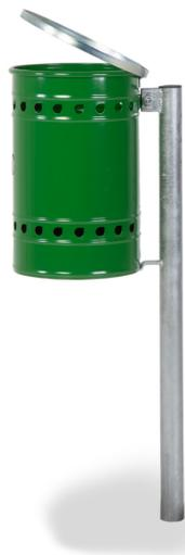
Cestino di forma cilindrica in lamiera di acciaio bordata e con fori decorativi. Paletto di sostegno in tubo tondo di acciaio Ø 50 mm e altezza cm 120 interamente zincato a caldo. Il cestino è zincato e verniciato a forno a 180° C ed è munito di fermasacco di acciaio zincato. Sganciamento del cestino con chiave a brugola fornita in dotazione. Disponibile, con sovrapprezzo, in altri colori. Colorazione: Verde Ral 6002 **Disponibile nelle versioni:**
