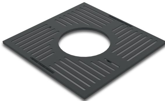
Griglia salva alberi realizzata in fusione di ghisa trattata con primer e verniciata a forno. Fornita in kit di due pezzi. Foro centrale Ø 45 cm. Colorazione: Grigio Micaceo. Articolo versione **TIPO B** (FILO PAVIMENTO) munito di attacchi in acciaio zincato per l'ancoraggio da interrare. L'articolo viene fornito in **kit di montaggio**.
