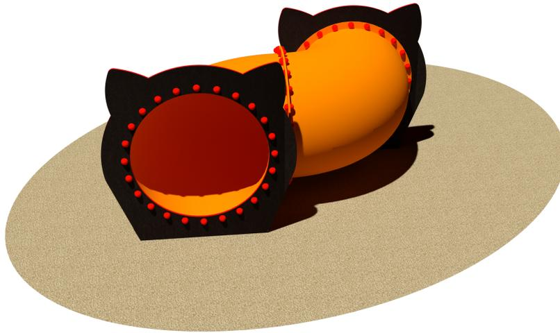
Realizzato con n° 2 elementi circolari cilindrici e curvi in vetroresina lavorata con vari strati di resina ad alta densità e n° 2 pannelli decorativi, di ingresso e uscita, realizzati in multistrato di betulla ad incollaggio fenolico, con zigrinatura antiscivolo, e rifinitura con film colorati in entrambi i lati. Assemblaggio mediante bulloneria in acciaio zincato 8.8 e dadi autobloccanti. Elementi copridado a norma in nylon colorato.
