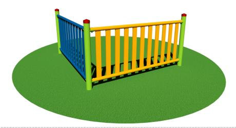
Realizzata interamente in acciaio zincato e verniciato a forno a 180 °C. I moduli hanno una lunghezza di 200 cm. Ogni modulo è costituito da un montante in tubo tondo Ø 89 mm e una barriera composta da due tubolari orizzontali Ø 50 mm e undici tubolari verticali sezione 80×20 mm. Fornita al cliente in kit di montaggio, comprensivo di un montante di chiusura. Disponibile nella sola versione *TIPO A* (da INTERRARE). L'articolo viene fornito in *kit di montaggio*.
