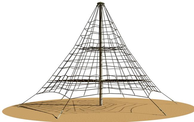
Certificato in conformità delle Norme Europee EN 1176 dall'Istituto TÜV-RHEILAND. Costituito da un montante principale in acciaio zincato a caldo assemblato ad una rete piramidale mediante connettori in alluminio. La rete piramidale è composta da fune armata Ø 18 mm. Disponibile nella sola versione **TIPO A** (da INTERRARE). L'articolo viene fornito in **kit di montaggio**.
