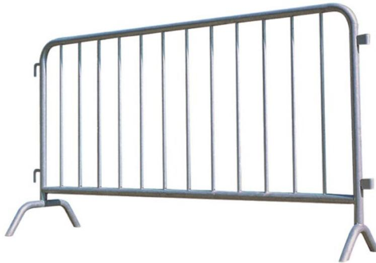
Lunghezze cm. 200 e 250. Altezza cm. 110. Zincatura a caldo. Struttura in tubo tondo di acciaio da  $\varnothing$  mm. 35, sbarre verticali in tondo pieno da  $\varnothing$  mm. 10. Aggancio rapido con due ganci e due graffe laterali. Art.114 Transenna Classica da cm 200x110h - Peso kg 14,5 Art.115 Transenna Classica da cm 250x110h - Peso kg 16,7
