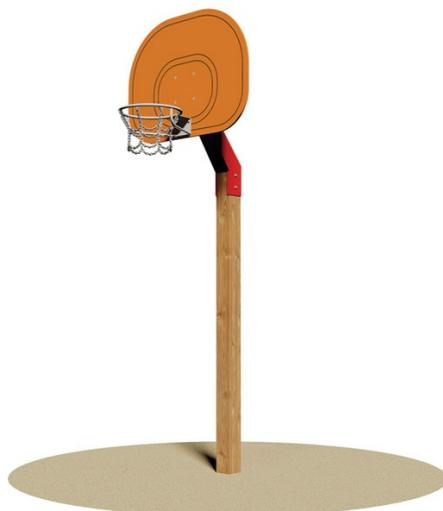
Struttura realizzata con palo in legno lamellare di pino nordico impregnato in autoclave con sali atossici, sez. cm 14x14. Il pannello basket, dimensioni cm 100x130, è in bilaminato stratificato HPL spessore mm 20, pantografato, colorato e con spigoli arrotondati. Il collegamento avviene tramite robusti attacchi in lamiera zincata e verniciata.
