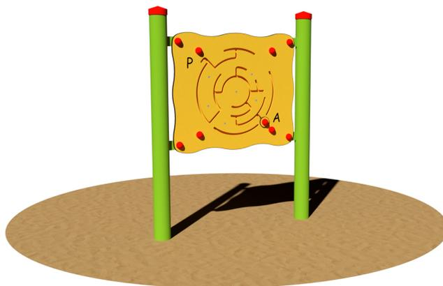
Certificato in conformità delle Norme Europee EN 1176 dall'Istituto Tedesco TÜV-SÜD. Realizzato con struttura portante in tubolari tondi di acciaio elettrozincato e verniciato aventi la sez. Ø 89 mm, collegati ad un pannello labirinto in bilaminato stratificato HPL pantografato e privo di spigoli. Verniciatura a forno a 180° C. Assemblaggio con bulloneria in acciaio zincato 8.8 e dadi autobloccanti. Elementi copridado e copripalo a norma in nylon colorato. **Disponibile nelle versioni:**
