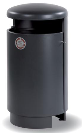
Cestone portarifiuti di forma cilindrica, con struttura portante in tubolare quadro sez. mm 20x20 e rivestimento in lamiera zincata 10/10 bordata. È completo di tettuccio bombato, apertura frontale per lo svuotamento e anello fermasacco. Sistema di apertura/chiusura mediante chiavino in dotazione. Verniciatura a forno 180°C in polvere poliestere con elevata resistenza agli agenti atmosferici e alle radiazioni UV. Colorazione: Grigio micaceo. L'articolo viene fornito preassemblato.
