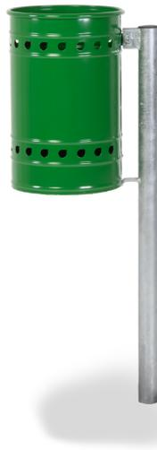
Cestino per rifiuti urbani Milano verniciato con paletto. Cestino di forma cilindrica in lamiera di acciaio bordata e con fori decorativi. Paletto di sostegno in tubo tondo di acciaio Ø 50 mm e altezza cm 120 interamente zincato a caldo. Il cestino è zincato e verniciato a forno a 180° C Sganciamento del cestino con chiave a brugola fornita in dotazione. Disponibile, con sovrapprezzo, in altri colori. Colorazione: Verde Ral 6002
