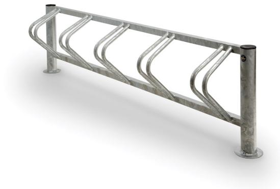
A cinque posti, interamente zincato a caldo. Realizzato con struttura portante in tubo tondo di acciaio Ø 80 mm e traverse in tubo quadro sezione 40x40 mm. Elementi di parcheggio biciclette in tubo tondo di acciaio Ø 25 mm. Munito di piastre per l'ancoraggio al terreno.
