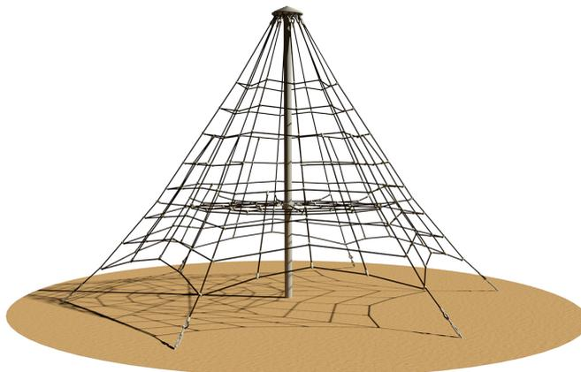
Certificata in conformità delle Norme Europee EN 1176 dall'Istituto TÜV-RHEILAND. Costituita da un montante principale in acciaio zincato a caldo, assemblato ad una rete piramidale mediante connettori in alluminio. La rete piramidale è composta da fune armata Ø16mm. Disponibile nella sola versione **TIPO A** (da INTERRARE). L'articolo viene fornito in **kit di montaggio**.
