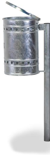
Cestino di forma cilindrica in lamiera di acciaio bordata e con fori decorativi. Paletto di sostegno in tubo tondo di acciaio Ø 50 mm e altezza cm 120. Entrambi sono completamente zincati a caldo. Il cestino è munito di dispositivo ferma sacco in acciaio zincato. Sganciamento del cestino con chiave a brugola fornita in dotazione.
