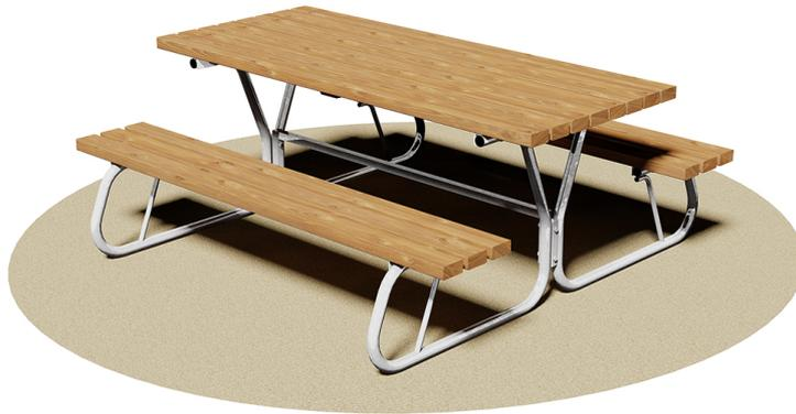
Struttura composta da telaio in tubo tondo Ø 40 mm zincato a caldo e legno di pino nordico impregnato in autoclave con sali atossici.
