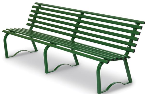
Conforme alla Norma UNI 11306:2009. Struttura con n° 3 supporti in tubo quadro di acciaio sezione mm 30x30, di forma anatomica. Lunghezza cm 200. Scocca composta da dodici profili in acciaio di sezione ovale mm 40 x 20 dotati di tappi in plastica alle due estremità. Fissaggio ai supporti mediante bulloneria in acciaio zincata. Predisposta per l'ancoraggio nel terreno. La panca viene fornita al Cliente in kit di montaggio. Interamente verniciata a forno 180°.
